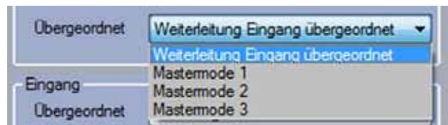
Informationen zu dem Aufbau siehe Kapitel "Kaskadierung mehrerer iVent 8A Lüftungszentralen". Im Auslieferungszustand ist der Modus "Weiterleitung des Eingangs Übergeordnet" voreingestellt.
